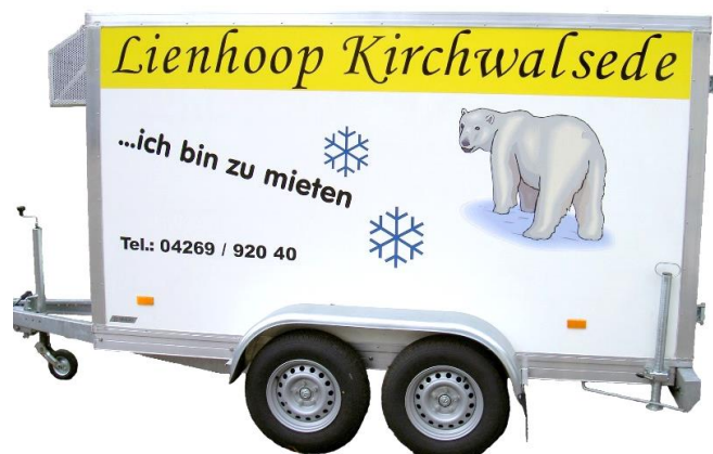
Kühlanhänger 2,7 t abschließbar Zuladung ca. 1900 kg Innenmaße: B: 1,35 m H: 1,70 m T: 3,15 m
