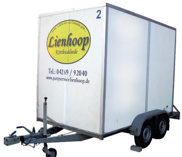
Transportanhänger 2,0 t abschließbar, mit Laderampe Zuladung ca. 1250 kg Innenmaße: B: 1,75 m H: 2,20 m T: 3,00 m
