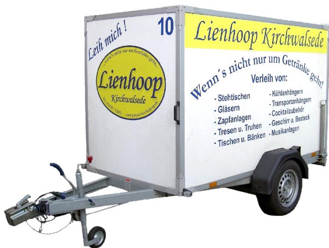
Transportanhänger 1,3 t abschließbar Zuladung ca. 850 kg Innenmaße: B: 1,25 m H: 1,50 m T: 2,50 m
