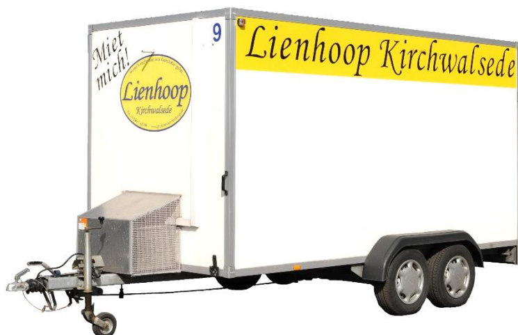
Kühlanhänger 2,5 t abschließbar, mit Laderampe Zuladung ca. 1600 kg Innenmaße: B: 1,80 m H: 2,05 m T: 4,00 m
