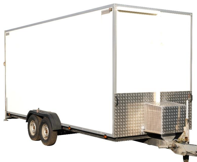
Kühlanhänger 3,5 t abschließbar Zuladung ca. 1800 kg Innenmaße: B: 2,00 m H: 2,50 m T: 6,00 m
